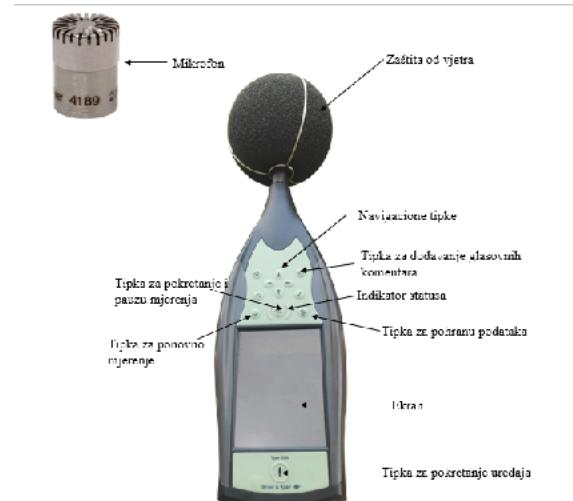
Slika 4. Osnovne komponentne bukomjera Brüel&Kjaer tip 2250
